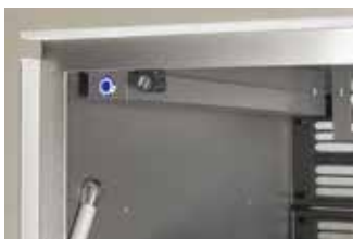
Interrupteur tactile et contrôleur d'intensité lumineuse
