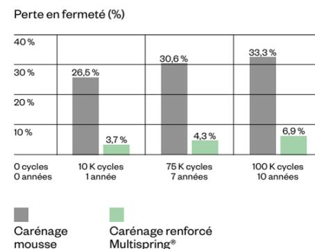
Essai de résistance et de maintien de la fermeté du carénage ressort : carénage en mousse contre carénage Multispring®.
